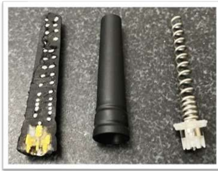
Antenne surmoulée d'élastomère
