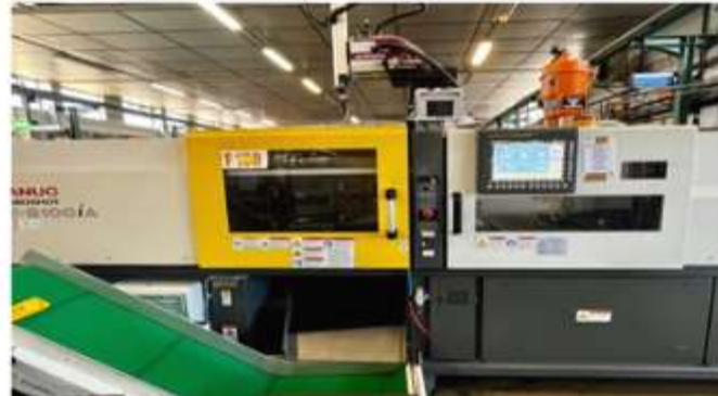
INJECTION MACHINE #2 : FANUC F100 T
